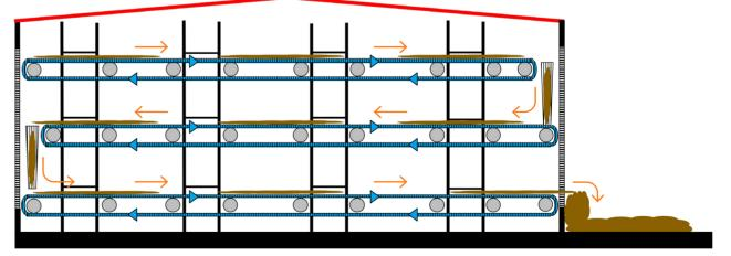
Imagen 18: Túnel de secado de estiércoles sólidos
